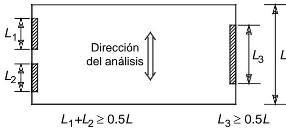
**Figura 3.7** Requisito sobre muros de carga perimetrales paralelos
