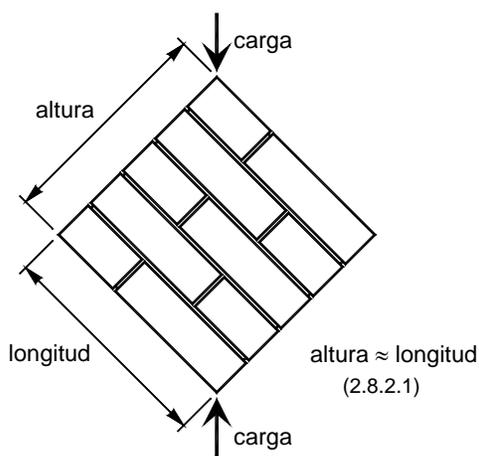
**Figura 2.3 Murete para prueba en compresión diagonal**
