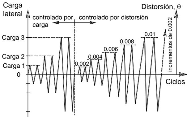
Carga 1 = 0.25 veces la carga calculada de agrietamiento o fluencia
