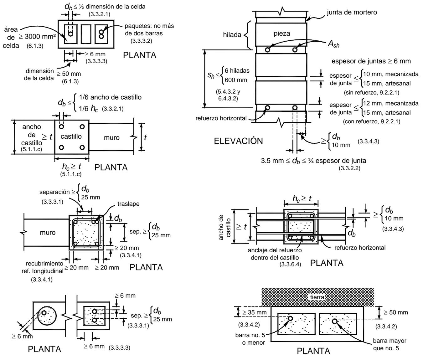
**Figura 3.8** Tamaño, colocación y protección del refuerzo
